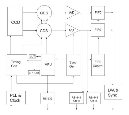
FIGURE 20. TM-6710CL Block Diagram
